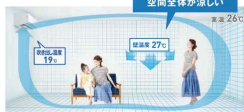
床・壁温度センシング(可動センサー)
